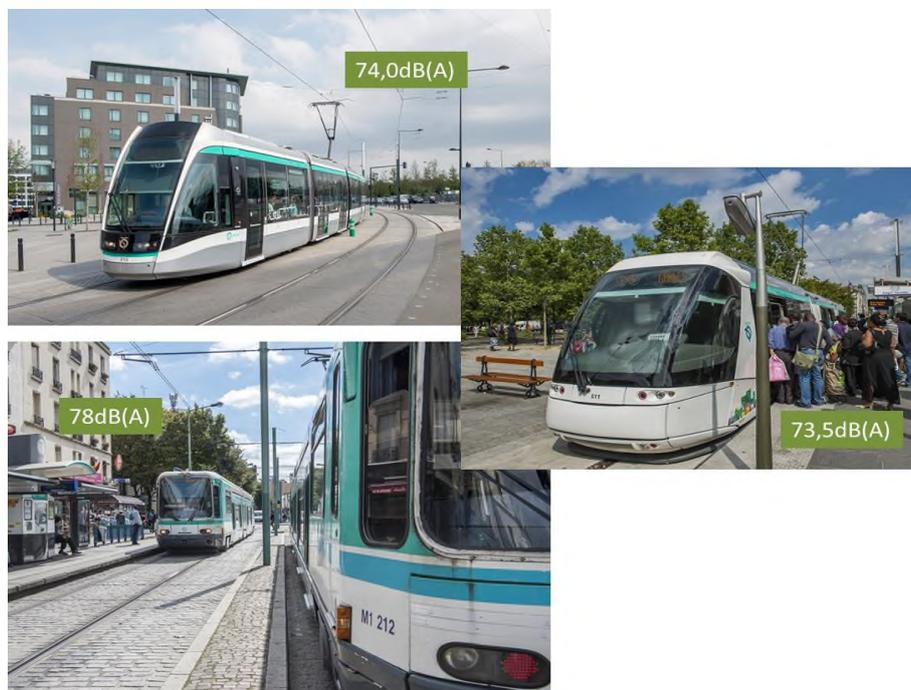
**Figure 9 : Niveaux sonores, en dB(A), de divers tramways circulant, à 40km/h et à 7,5m de l'axe de la voie (NF EN ISO 3095).**
